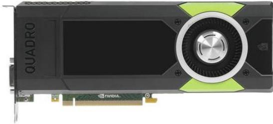
Видеокарта Quadro M5000, основой для которой выбран графический процессор Quadro M5000, способна работать с наиболее сложной графикой фотореалистичных видеоигр. Используя модули памяти формата GDDR5, карта отличается впечатляющим объемом видеопамати в 8 Гб. В процессе работы ее охлаждает до оптимальной температуры один центробежный вентилятор-турбина, работающий с минимальным уровнем шума.
